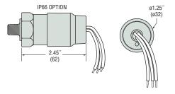
RIGHT ANGLE DIN 43650A WITH CABLE CLAMP
